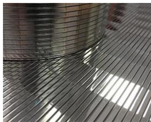
плоскость решетки и щели решетки не забиваются (эффект Коберли), легкая очистка поверхности путем промывки щелевой плоскости, допустима автоматизированная промывка подачей обратного давления
